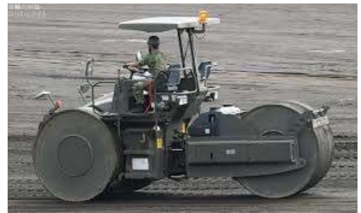
転圧用のロードローラー(ネットより)
